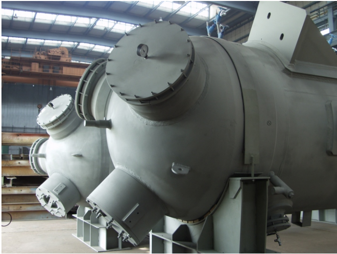
Montaż końcowy wysokoprężnych wymienników ciepła Final assembly of HP type heat exchangers
