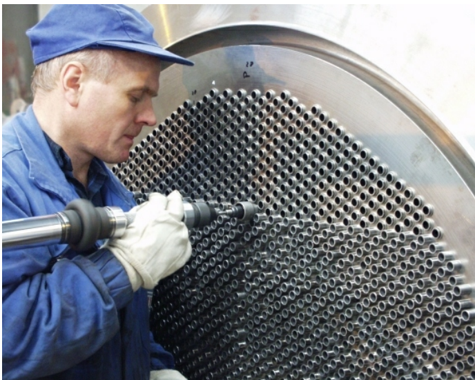
Rozwalcowanie końców rurek w ścianie sitowej Tube tips expanding in tubesheet
