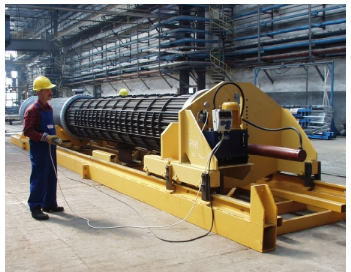
Montaż wkładu rurowego do płaszcza wymiennika Putting of tube bundle into heat exchanger shell
