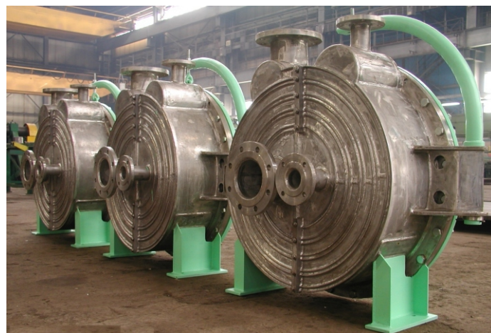
Spiralne wymienniki ciepła do podgrzewania osadów Spiral-tube heat exchangers for sludge preheating
