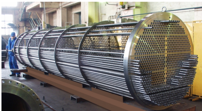
Wymiennik płaszczowo-rurowy podczas montażu Shell and tube heat exchangers during assembly
