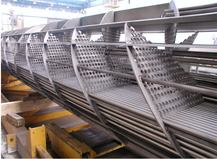
Montaż wymiennika ciepła typu "helixchanger" Assembly of "helixchanger" type heat exchanger
