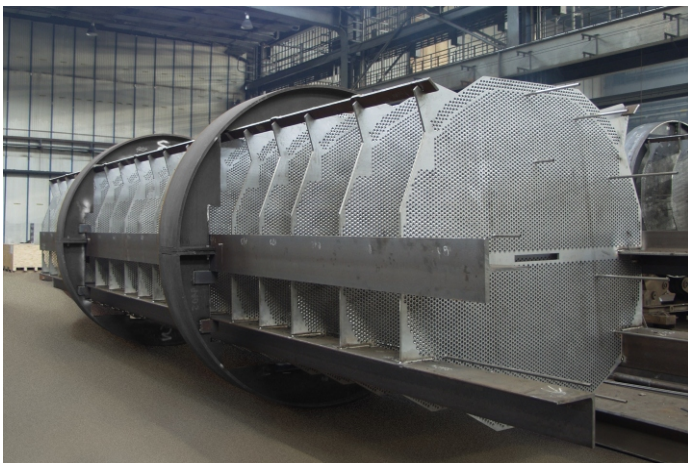
Montaż 20-metrowego podgrzewacza niskoprężnego dla elektrowni atomowej Assembly of a 20-metre LP preheater for nuclear power plant
