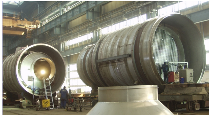
Wyparka jako przykład wymiennika ze stałą ścianą sitową Evaporator as an example of heat exchanger with fixed tubesheet
