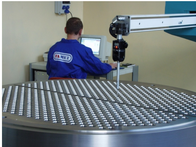
Pomiar ściany sitowej na maszynie 3D Measurements of tubesheet on 3D measurement machine
