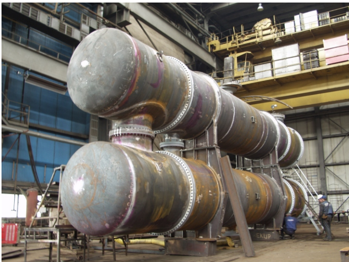
Montaż próbny zespolonych wymienników ciepła Trial assembly test of shell and tube heat exchangers installed as stacked unit
