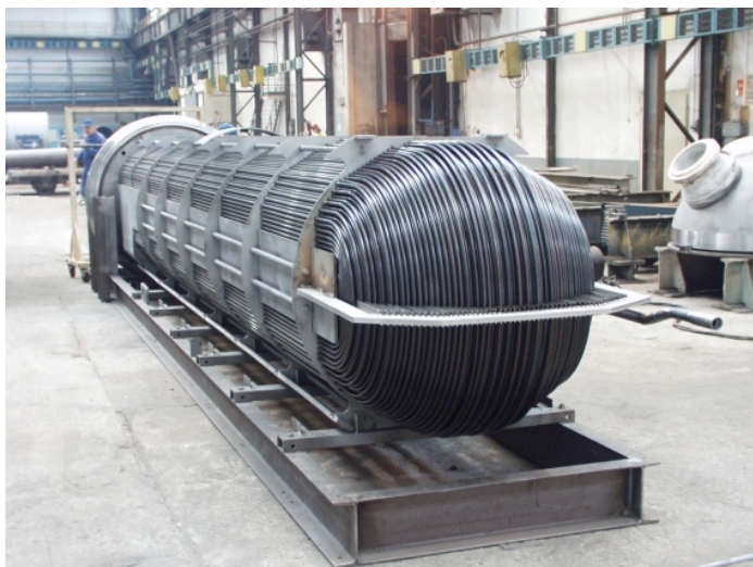
Montaż U-rurowego wymiennika ciepła Assembly of U-tube heat exchanger
