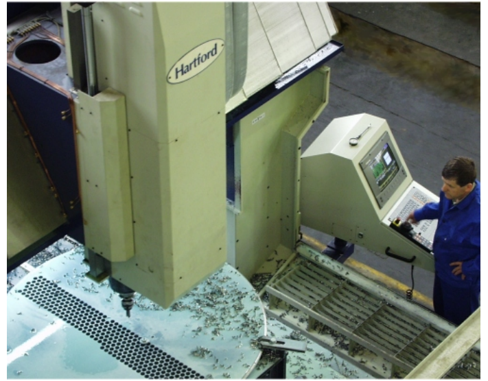
Wiercenie otworów w dnie sitowym Drilling of heat exchanger tubesheet
