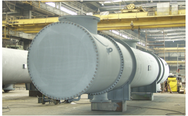
Wymienniki ciepła ze stałymi ścianami sitowymi wyprodukowane dla kompleksu petrochemicznego Heat exchangers with fixed tubesheets manufactured for petrochemical plant
