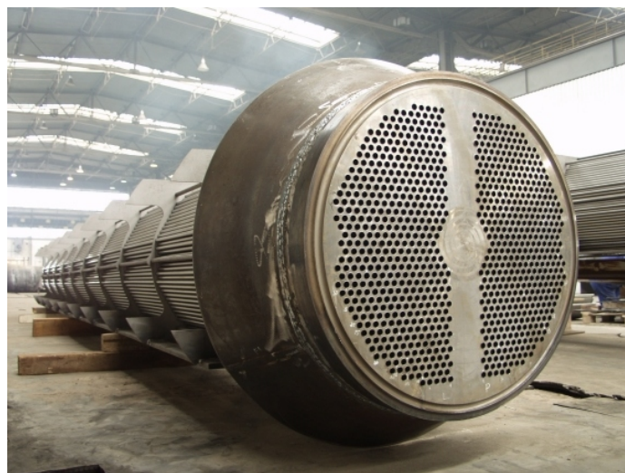
Widok ściany sitowej U-rurowego wymiennika ciepła View of tubesheet of U-tube heat exchanger
