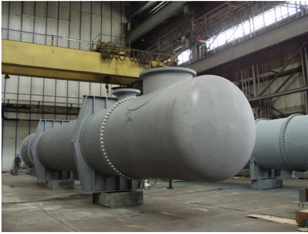
Wymienniki ciepła ze stałymi ścianami sitowymi wyprodukowane dla kompleksu petrochemicznego Heat exchangers with fixed tubesheets manufactured for petrochemical plant
