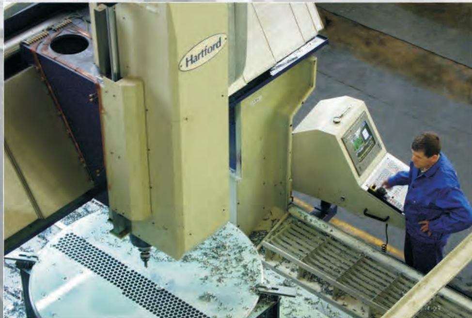
***Bohrungen in Rohrböden***
