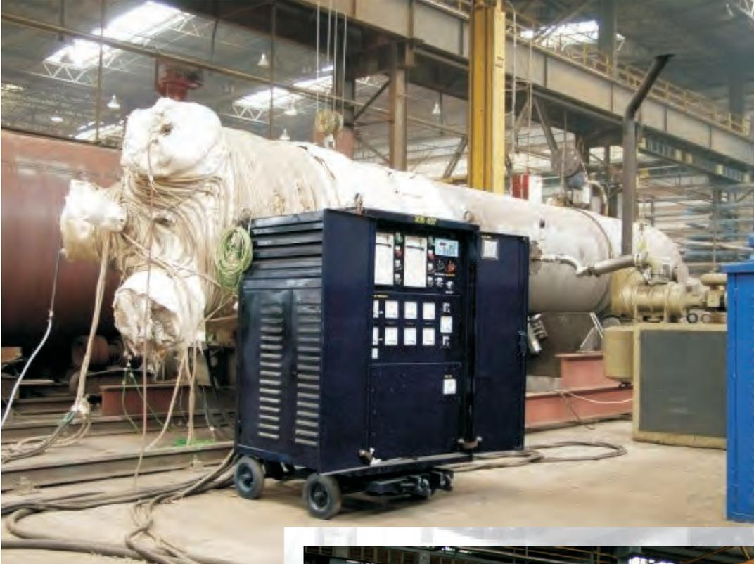
*Wärmebehandlung nach dem Schweißen für Hochdruck-Regenerativvorwärmer*
