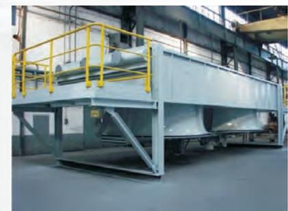
*Luftkühlerbatterie für Erdgas*
