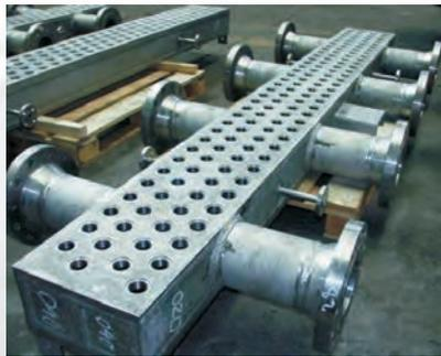
*Bearbeitung von Luftkühlerkammern
