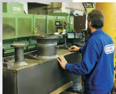
**Ultraschallprüfung der Kammern
