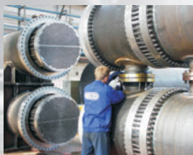
Montaż próbny zespolonych wymienników płaszczowo-rurowych
