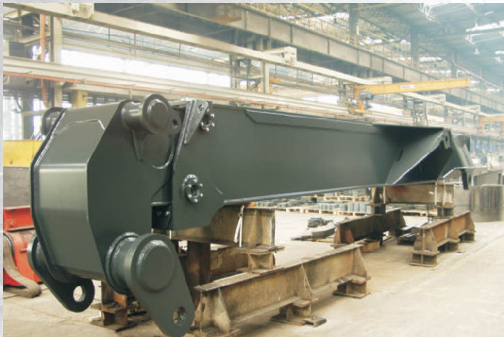
Wysięgnik przeznaczony do ciężkiej maszyny przeładunkowej (45t)
