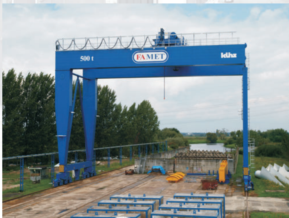
Suwnica bramowa o udźwigu 500 ton
