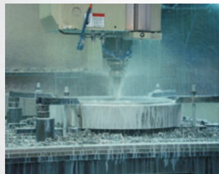
Wiercenie otworów w dnie sitowym
