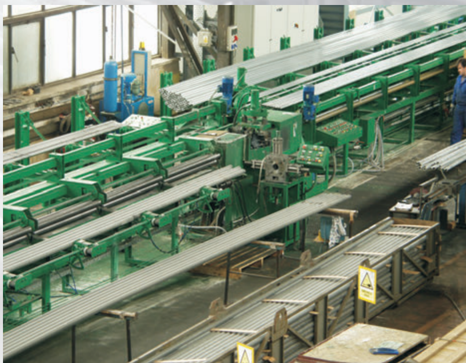
Maszyna do żebrowania rur (o długości 15,5 m)
