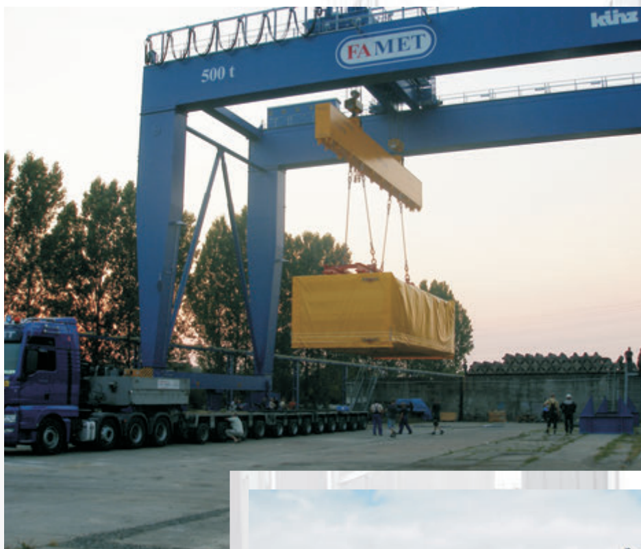
Suwnica bramowa o udźwigu 500 ton
