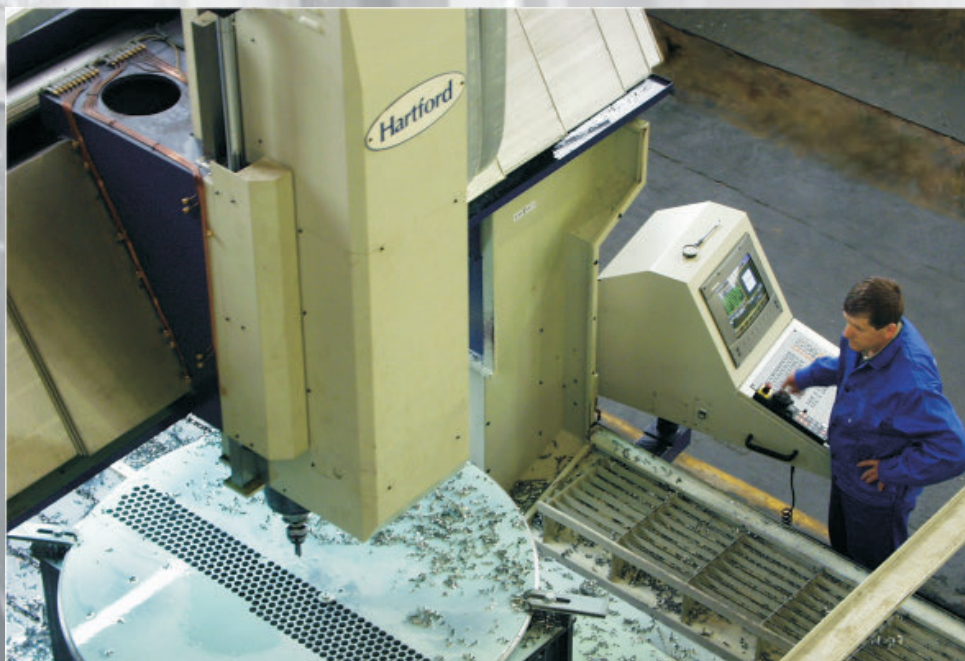
Wiercenie otworów w dnie sitowym
