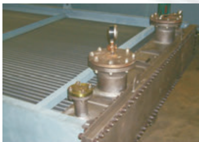
Próba hydrauliczna wiązki rurowej
