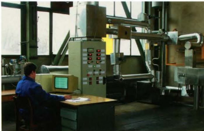
Испытательный стенд ребристых трубных пучков. Testing facility of finned tubes bundles.
