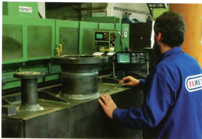
Ультразвуковые испытания камер после сварки. US testing of welded headers.
