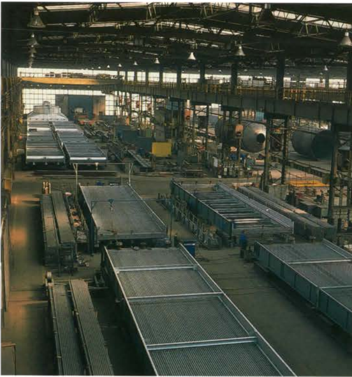
Монтаж трубных пучков. Assembly of tube bundles.
